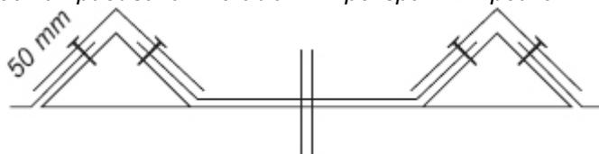
*Ширина рейки 70 мм. Расстояние между рейками 600 мм. Расстояние между углами, образованными верхними гранями соседних реек 670 мм*
